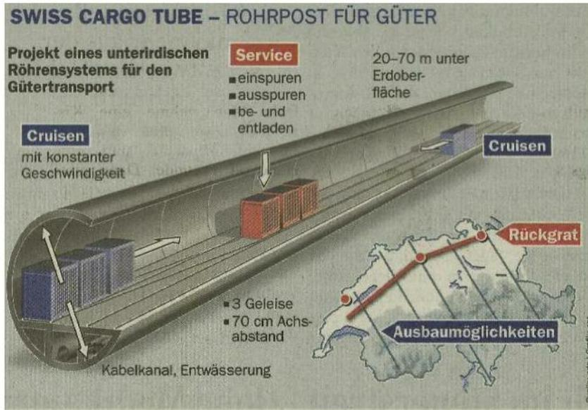
In einem unterirdischen Röhrensystem sollen quer durch das Land Güter transportiert werden. Noch ist die «Poströhre» eine Vision.
