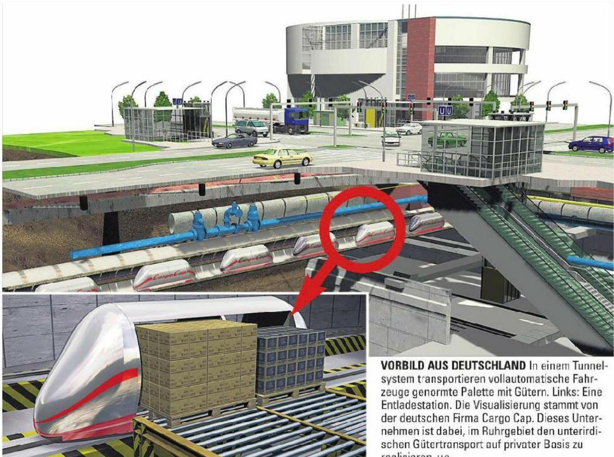
**VORBILD AUS DEUTSCHLAND** In einem Tunnel-system transportieren vollautomatische Fahr-zeuge genormte Palette mit Gütern. Links: Eine Entladestation. Die Visualisierung stammt von der deutschen Firma Cargo Cap. Dieses Unter-nehmen ist dabei, im Ruhrgebiet den unterirdischen Gütertransport auf privater Basis zu realisieren. HO
